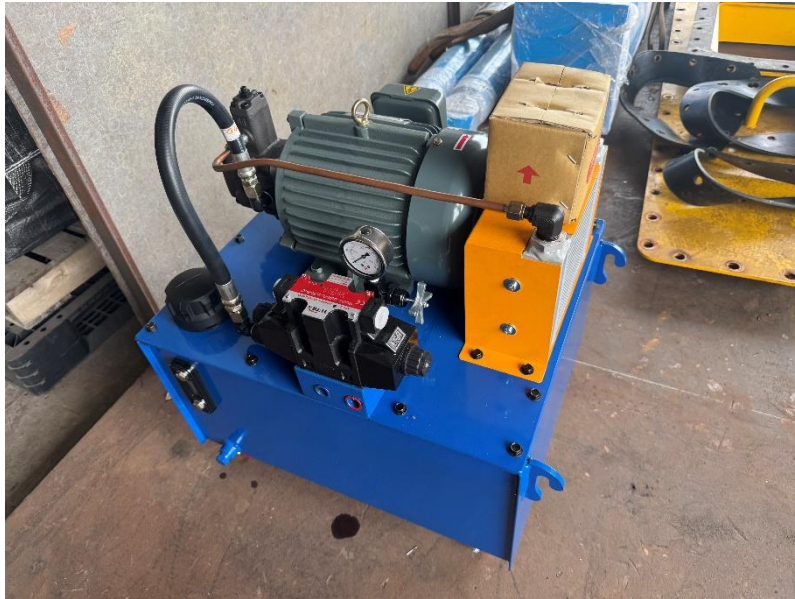
圖 6、波浪發電集成式基座液壓動力模組示意圖
